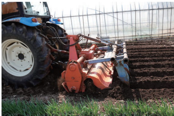
트랙터를 이용하여 흙과 거름을 섞이게 하는 로터리 치기와 감자골지르기를 동시에 하는 장면
